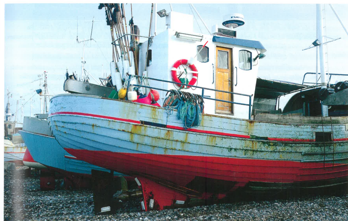
"Det er skruevandet der styrer" har været bådebyggerne Mortensens udgangspunkt for udformningen af de store Klitmøllerbådes evne til at løbe i søen, "tage rend" som mølboerne siger. Her illustreret med en lang, svungen hæk på havbåden Danmark, der sikrer, at propeller og ror forbliver dybt nede i vandet under alle forhold (øverst), og Nordsøens krydserhæk (nederst), der regnes for robust, samtidig med at den tager blødt imod en sø, der kommer rullende agtenfra. Lild Strand 1995.
