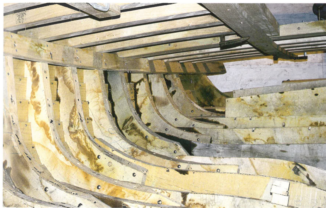
Spantesystemet i agterskibet danner skrogets evne til at absorbere de voldsomme stød nedefra, kølen tager imod, når båden falder med bølgerne ned på reulene under udsætning og landing på stranden. (Fortsættes på næste planche.)
