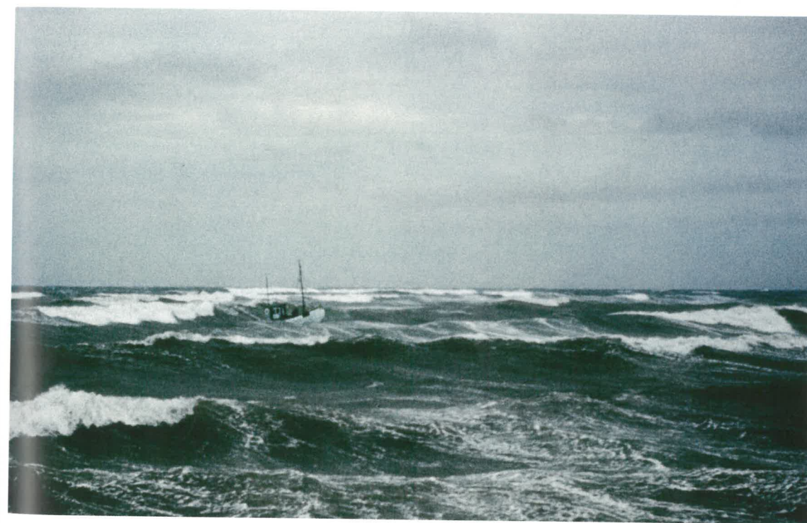
At ride på forkanten af en høj sø indebærer faren for, at forskibet skærer på tværs, og båden kæntrer. Der er to diametralt modsatte måder at ophæve denne fare på. Man kan som thyboerne sætte farten op, så forskibet planer ud af vandet, og man kan som hanboerne sætte farten ned, så forskibet ligger stille i vandet og følger med dets bevægelse.
