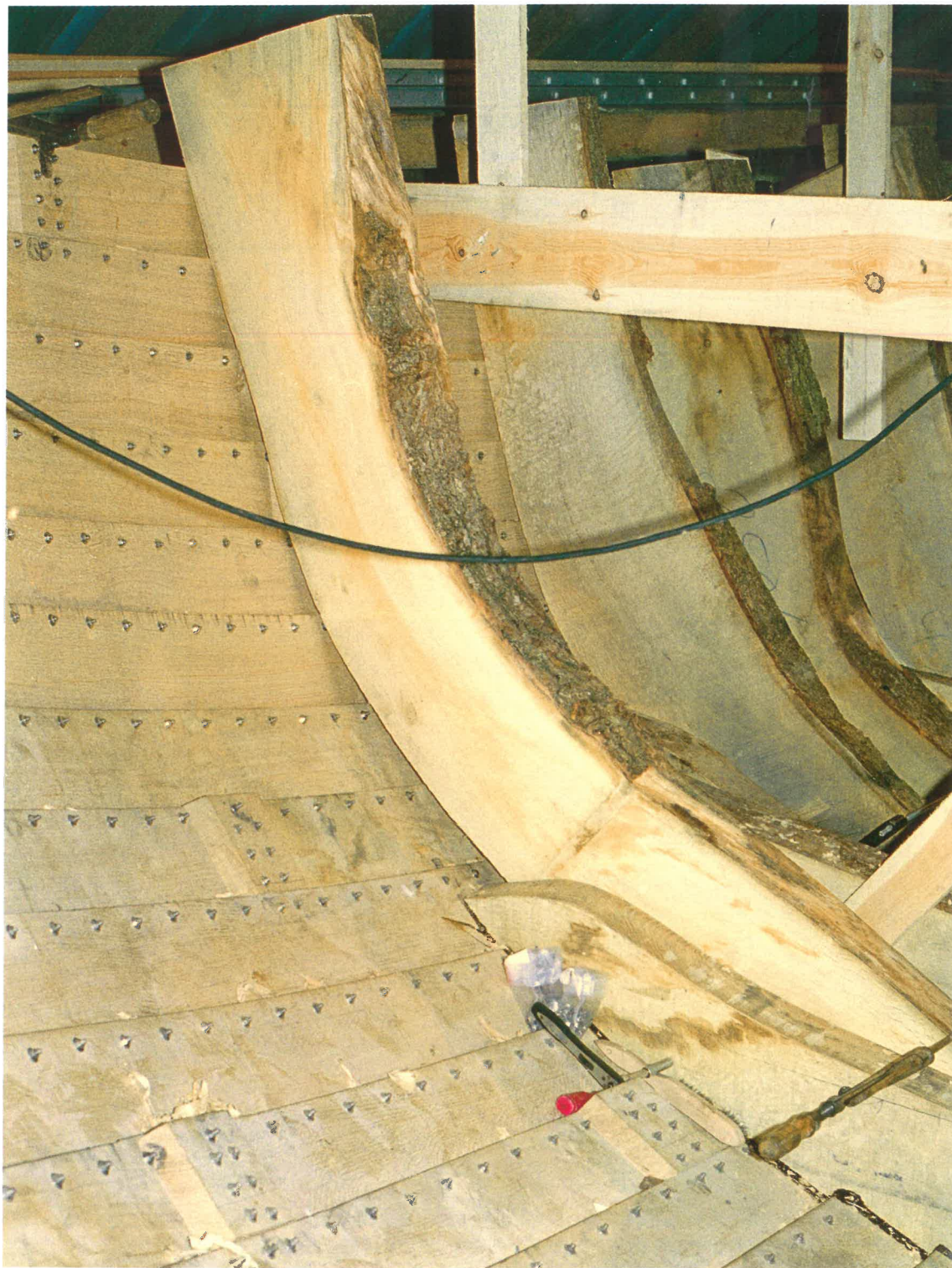
Fortsat fra planche 11: Jo bredere og tungere agterskib, desto højere spanter skal der til for at ophæve disse stød gennem skrogets samlede elasticitet. Bord og spanter danner tilsammen et væv af langsgående og tværgående træfibre. Under motor, gear og skrueaksel ligger lange, facongroede bundstokke, hvis styrke dannes af en hensigtsmæssig udnyttelse af egetræets naturgroede fiberstruktur, der forener modsætningen imellem agterskibets skarp og fylde.
