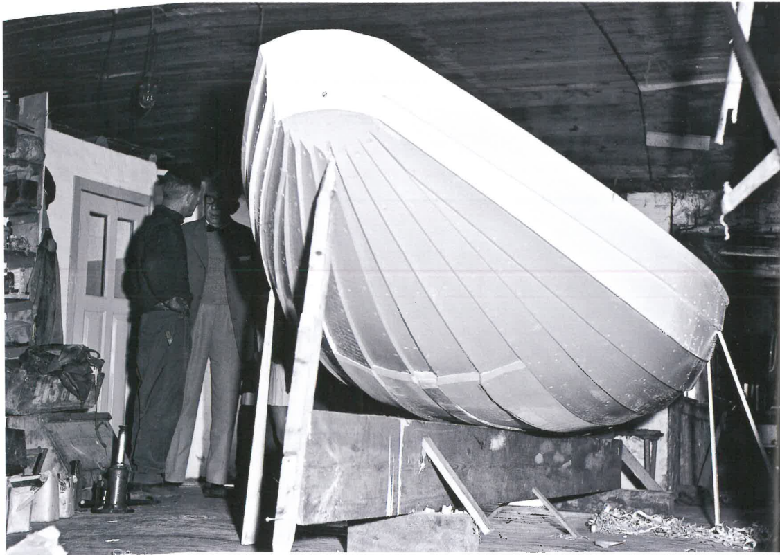
Havpram på sin stab mens den er under færdiggørelse på Eron Andersens bådbyggeri i Nørre Vorupør 1965. En havpram er som skabt til at løbe i en sø, fordi bunden samles op i en pramstævn uden noget skarp, hvilket gør prammen utilbøjelig til at skære på tværs af bølgens retning. Den kan lande op direkte i sandet løbende på en høj stoksø. Store, fyldige havpramme er kendt for at være nogle af de sidste fartøjer, der må søge land, fordi det blæser op.
