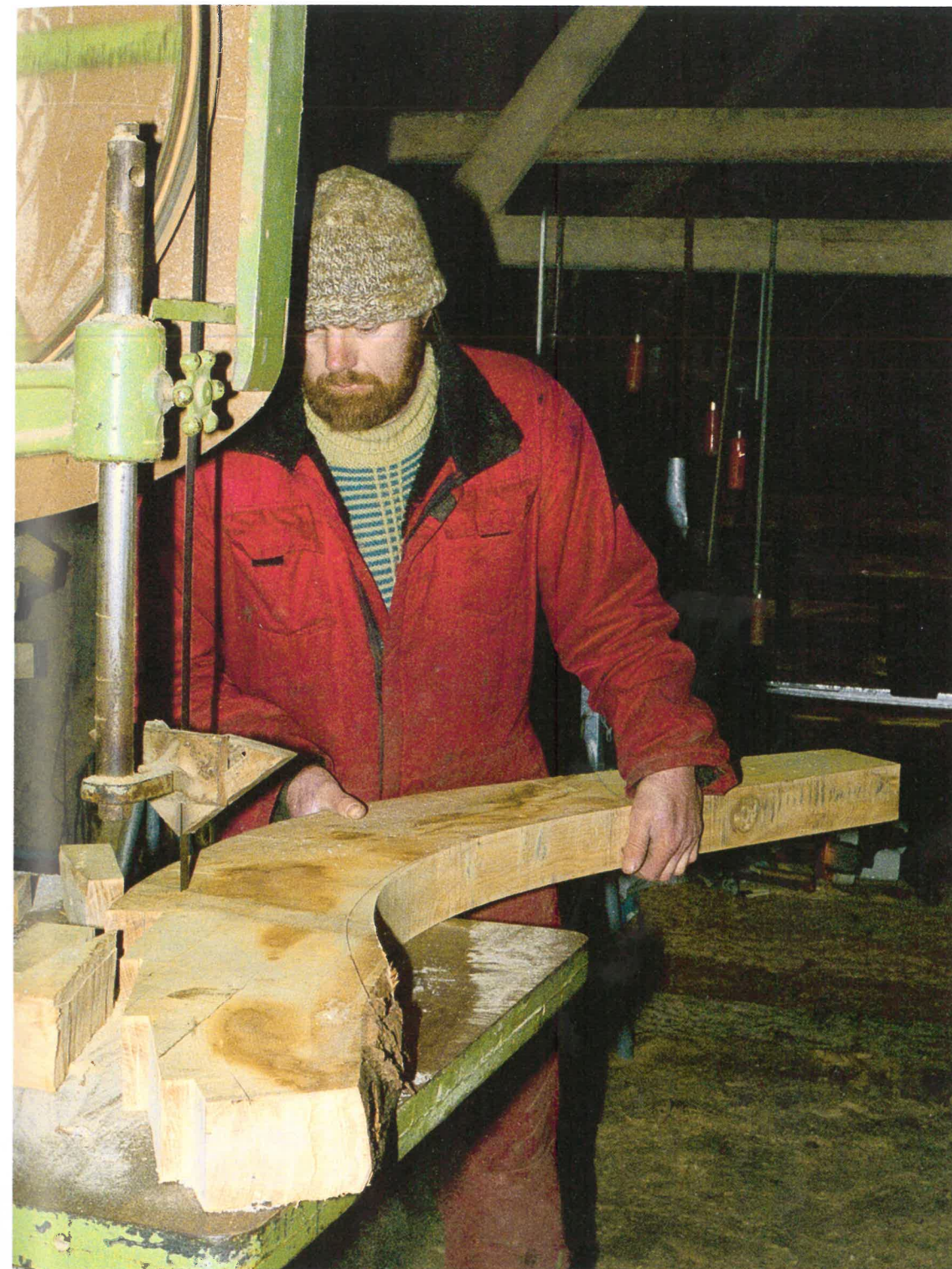
Bådebygger Peter Madsbøll på Kolsgaard i Øsløs lægger tømmer i sin nybygning. Bordenes kanter streges af på tømmeret og saves ud på båndsav.
