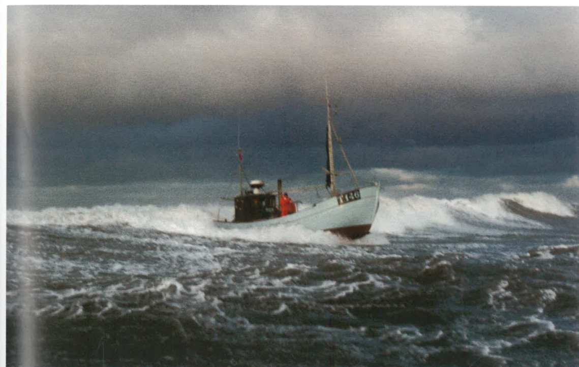
Bemærk den erfarne besætnings afslappede ophold på dækket, mens Duen buser ind over reulernerne. Forskibet planer ud af vandet og kan derfor holde kursen. Læg mærke til udstødningsrøgen fra maskinen, der går fuld kraft for at kunne styre med skruvandet.
