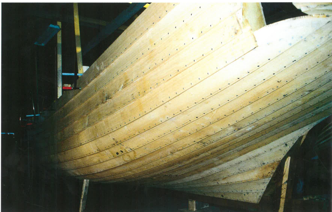
En bestemt negation og dens ophævelse. Agterskibets skarp under vandet tegner sig tydeligt som en modsætning til skrogets brede fylde over vandlinien. De forenes i 5. og 6. bordgangs kurve (nederst), der danner overgang imellem dem, og holdes sammen af den facongroede agterstævn af tætlåret egetræ (øverst), der er boltet solidt på kølen, og hvortil agterskibets spanter boltes fast.
