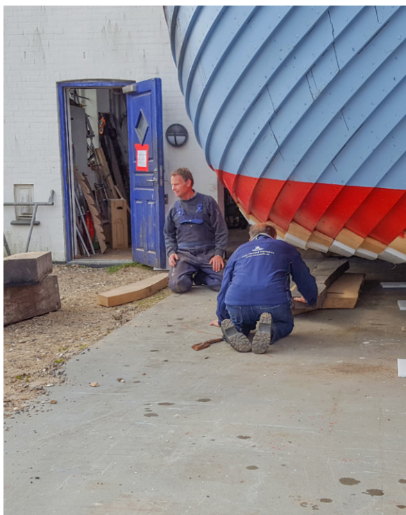
Der blev lagt nylonplader ud, som kølen kunne glide på, samt opklodsning ude i siderne. Foto: Pipsen
