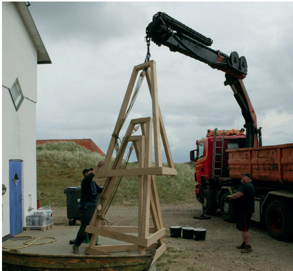
Til det nyåbnede Havets og Fjordens hus i Thorsminde har værftet lavet disse stativer. Her kan man prøve, hvad det betyder for den kraft, man skal hive med, når tovværket løber gennem enkelt- eller dobbeltblokke, og man skal løfte 50 kg. Foto: Pipsen
