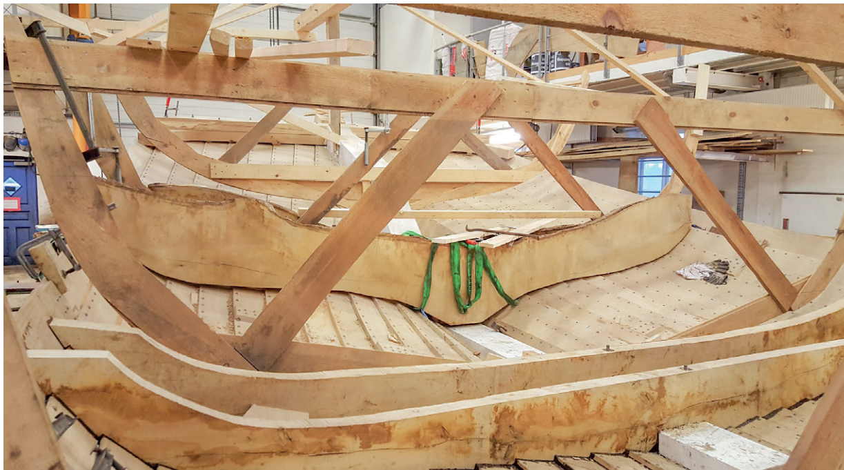
Et facongroet stykke egetræ skal tilpasses som bundstok til den nye båd til Thorupstrand. Foto: Pipsen
