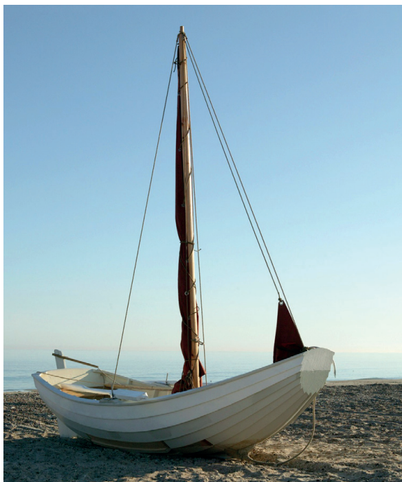
Den nybyggede havpram med sprydsejl. Værftet tager meget gerne imod bestillinger på nybygninger. Foto: Pipsen
